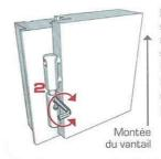
Le vantail frotte sur le sol ou les rouleaux butent sur les gâches à la fermeture.
